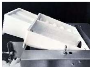
DETALHE DA INCLINAÇÃO DA CAIXA DE MASSA
